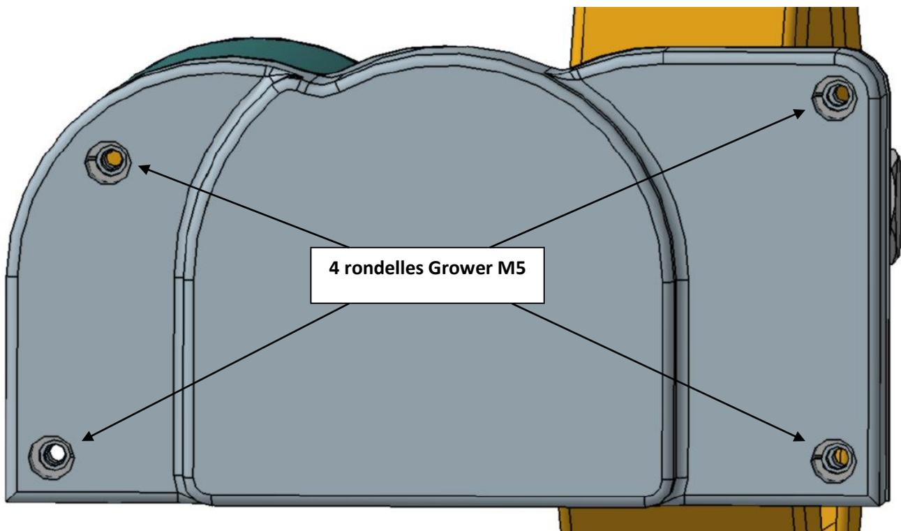
35- **Insérer** dans l'assemblage la pièce : -Vis CHC M5-12 (4 fois)
