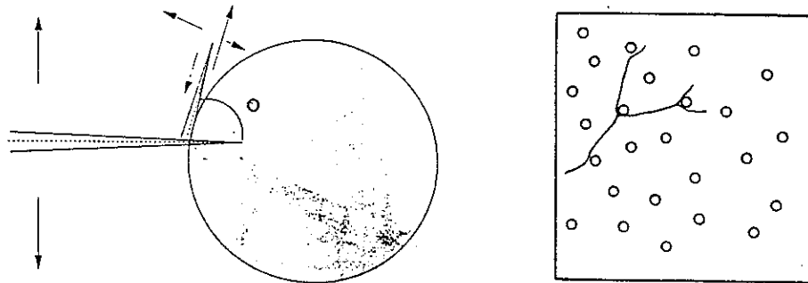
Figure 1.20 : Renforcement par déviation et multiplication de fissure.
