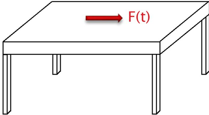
Soit une dalle anti-sismique de masse  $m$  soutenue par 4 poteaux. Les poteaux, de matériau, longueur et section identiques, sont encastrés au sol et articulés avec la dalle. Un séisme provoque une excitation sinusoïdale horizontale,  $F(t)$ , de la dalle.
