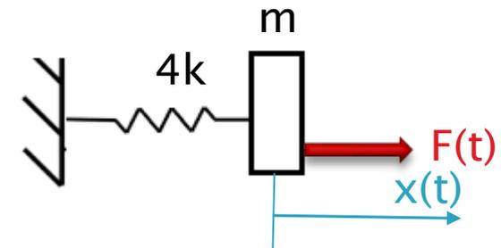
On peut **modéliser le comportement vibratoire horizontal** de la dalle par un système masse  $m$  + ressort de raideur  $4k$  (en négligeant l'amortissement)
