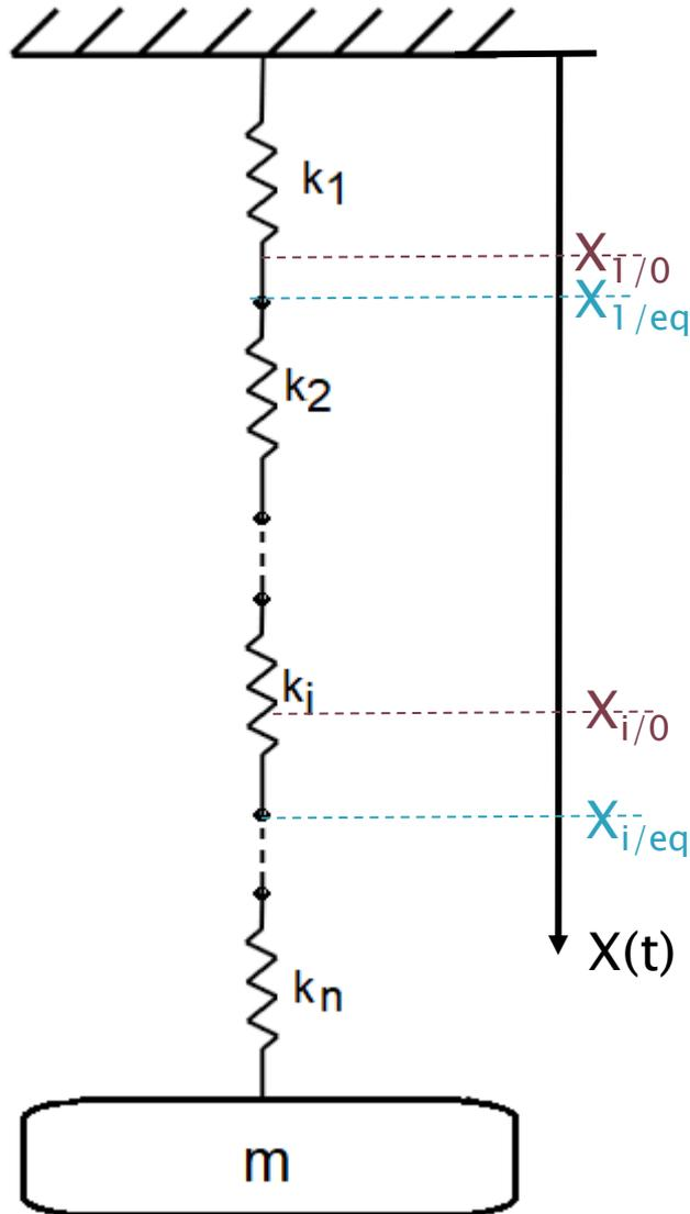
Soit  $\Delta X_i$  l'allongement du ressort n°i sous l'effet de la suspension de la masse  $m$ .
