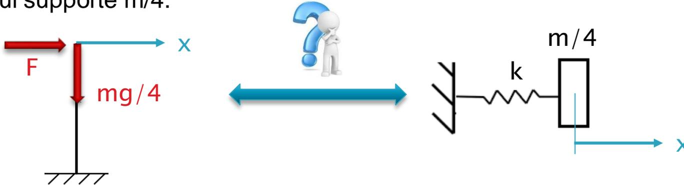
Pour identifier  $k$  dans l'oscillateur modélisant le comportement vibratoire du poteau, on suppose qu'un effort statique horizontal  $F$  est appliqué en haut du poteau.
