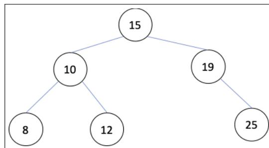
FIGURE 15.1 – Schéma illustrant un Arbre Binaire de Recherche.
